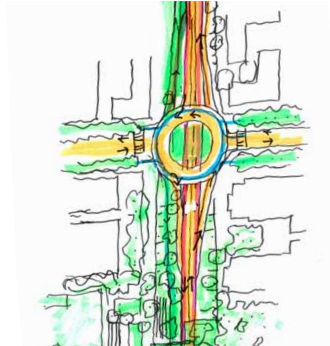
l'insertion dans la voie centrale s'effectue par un nombre de portes diminué et principalement par une bretelle depuis les giratoires existants ou à créer
